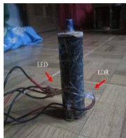
Gambar 8. Desain sensor kekeruhan LED dan LDR yang bersebrangan
