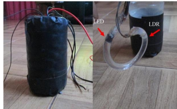
Gambar 6. Desain sensor kekeruhan bentuk lingkaran
