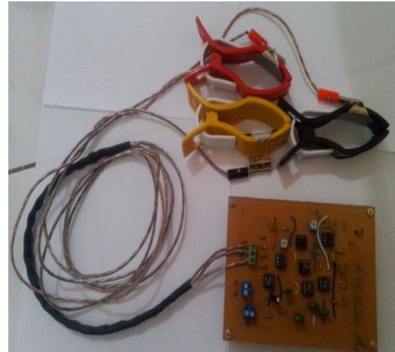
Gambar 4. Perangkat elektrokardiografi berbasis IC AD620
