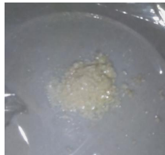
Gambar 3. Hasil kalsinasi \text{TiO}_2 pada suhu 400^\circ\text{C}
