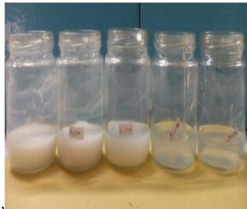
Gambar 2. Hasil preparasi TiO 2 dengan pelarutan CaCl 2 , methanol, dan TTIP
