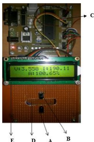
**Gambar 4.** Perangkat keras terdiri dari fotodiode (A), LED infra merah (B), mikrokontroler (C), media kaca (D), dan LCD (E).
