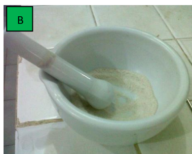
Gambar 3. Alumina yang dihasilkan dari percobaan: (a). alumina basah, (b). alumina bubuk.
