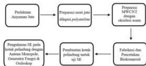
Gambar 1. Skematik Pengukuran Perisai EMI
