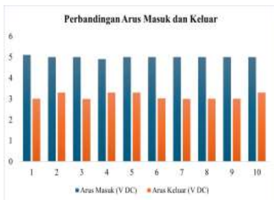
Gambar 12. Diagram Batang Arus Masuk dan Arus Keluar Pada LM2596
