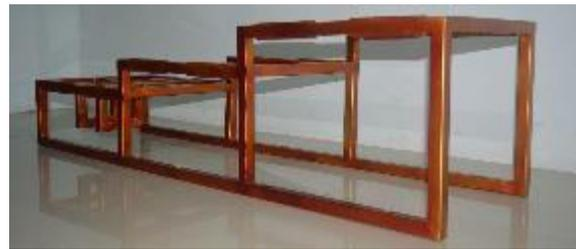
Gambar 7. Rangka bagian bawah konveyor
