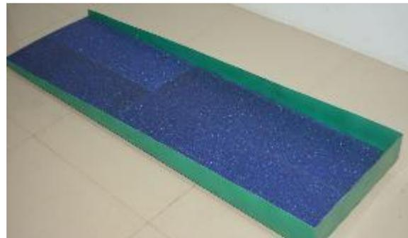
Gambar 8. Rangka bagian atas konveyor
