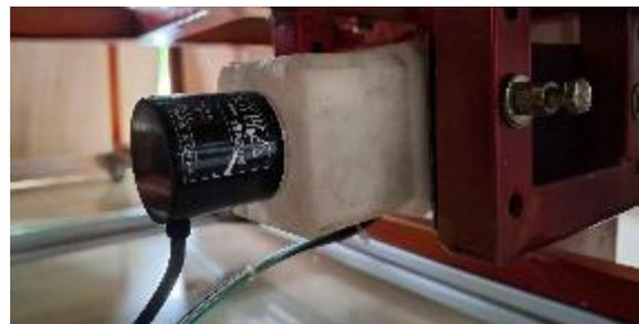
Gambar 3. Rotary encoder pada konveyor getar
