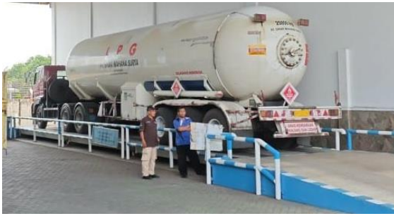
Gambar 2. Timbangan Jembatan Elektronik di Pabrik A
