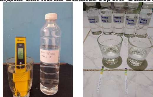
(a) (b) Gambar 5. Proses pengambilan data menggunakan pH (a) Digital dan (b) Kertas Lakmus
