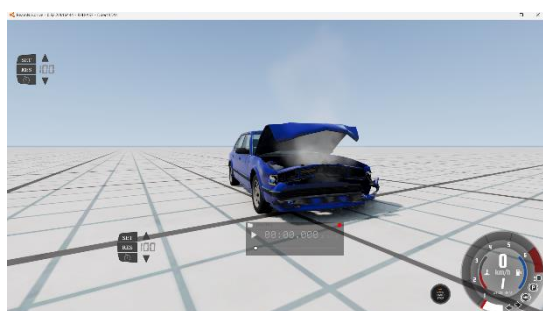
Gambar 6. Mobil A pada kecepatan 27,78 m/s
