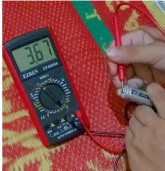
Gambar 3.3 Tegangan Baterai
