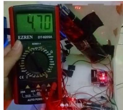
Gambar 3.6 Pengukuran output tegangan Step-Down
