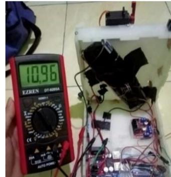
Gambar 3.4 Pengukuran Tegangan Baterai
