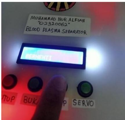
Gambar 3. 13 Pengujian tombol *stop*
