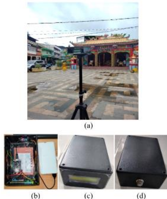
Gambar 3. Tampilan instrumen: (a) keseluruhan instrumen, (b) bagian dalam instrumen, (c) sisi LCD 16×2, (d) sisi belakang sensor MQ-135
