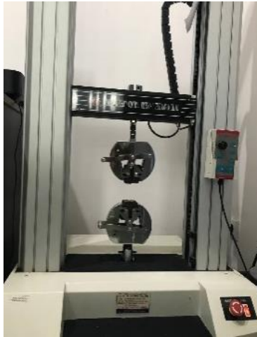
Gambar 3. Mesin uji tarik merk Hung Ta HT-2402 diproduksi negara Republik Rakyat Cina
