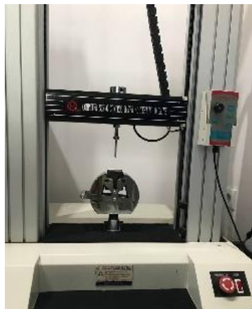
Gambar 4. Mesin uji tekuk merk Hung Ta HT-2402 diproduksi negara Republik Rakyat Cina
