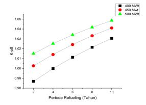
**Gambar 8**. Perubahan faktor multiplikasi efektif (k<sub>eff</sub>) selama waktu operasi 10 tahun
