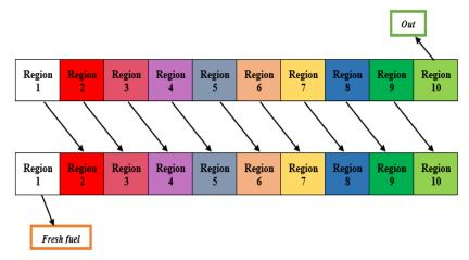
Gambar 1. Susunan bahan bakar arah radial
