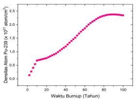
Gambar 7. Perubahan densitas atom Pu-239
