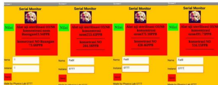
Gambar 6 Sistem monitoring alat sterilisasi masker anti virus covid 19 dengan android pada pensteril masker berbasis plasma non thermal .
