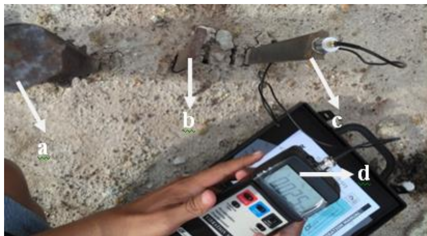
Gambar 2. Rangkaian Secara Keseluruhan yang terdiri dari (a) besi padat dengan masa 5 Kg, (b) batang besi 1, (c) batang besi 2, (d) vibration meter
