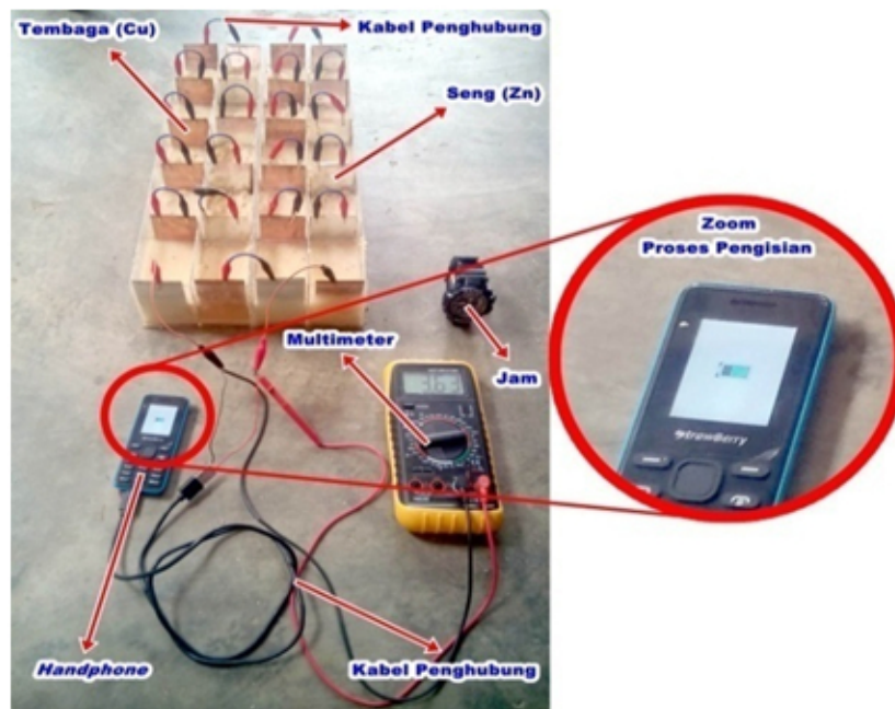
Gambar 7: Uji Pengisian baterai telepon genggam, langsung menghubungkan keluaran sel ke telepon genggam.
