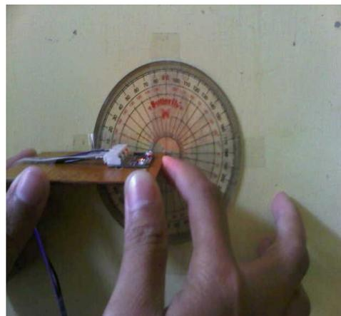
**Gambar 7.** Pengujian sensor terhadap perubahan kemiringan.
