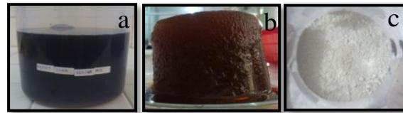
**Gambar 1.** Proses pembuatan silika dari sekam padi (a) filtrat silika sekam padi, (b) gel silika sekam padi, (c) bubuk silika sekam padi.
