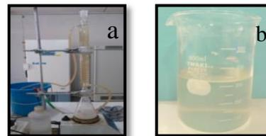
**Gambar 2.** Proses pembuatan sol silika (a) pembuatan sol dengan metode refluks, (b) sol silika.
